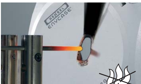
■ Brennverhalten Glühdrahtprüfung nach IEC 60 695-2-11: 960 °C, schwer entflammbar, selbstverlöschend
