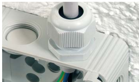
■ IP 65 mit Anbau-Kabelstutzen ADM 20. Der Anbaustutzen ist von einer Gehäuseseite ohne Gegenmutter montierbar.
